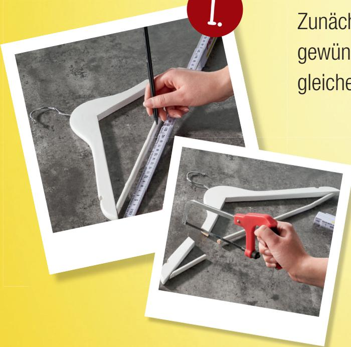
Zunächst werden alle Kleiderbügel in einer gewünschten Länge abgemessen und gleichermaßen mit einer Handsäge zugesägt.
