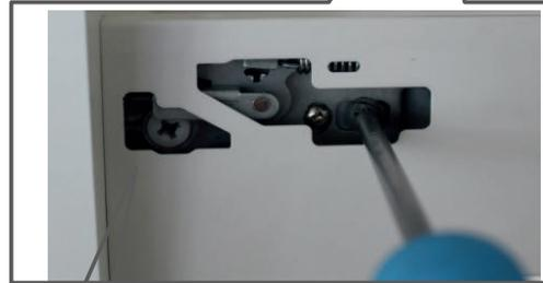
Mit Betätigung der hinteren Schraube wird die Front in der vertikalen Richtung eingestellt!
