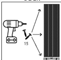
Die Paneele können ganz einfach verklebt oder verschraubt werden. Die digitale Version der Montageanleitung erhalten Sie durch Einscannen des QR-Codes oder über folgenden Link:
