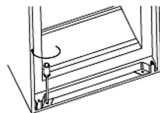
8. Befestigen Sie die obere Klammer mit den kurzen Schrauben am Schrank.
