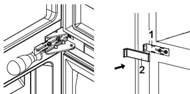
**1: Mittlere Klammer; 2: Abdeckung für mittlere Klammer**
