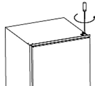
2. Schrauben Sie das mittlere Scharnier ab. Nehmen Sie dann die untere Tür ab und verwahren Sie diese an einem Ort, an dem sie nicht beschädigt werden kann.
