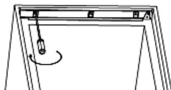
9. Dichten Sie die Lücke zwischen dem Schrank und der Türöffnungsseite des Gerätes mit dem Dichtband ab.
