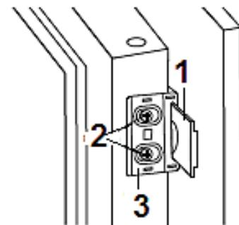
**1: Gleitelement; 2: Schrauben; 3: Führung**
