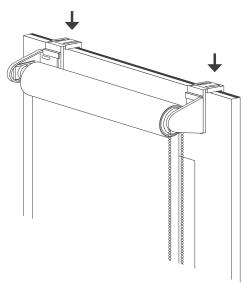
Fenster öffnen und Rollo fertig montiert beidseitig aufnehmen und auf den Fensterflügel einhängen. So positionieren, dass der Fenstergriff beim Abrollen nicht im Weg ist und der Stoff das Glas auf beiden Seiten gleichmäßig abdeckt.
