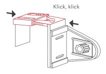
3 Die hinteren Teile der Klemmträger mit den vorderen Teilen, die sich bereits an den Rolloträgern befinden, zusammenführen. Dabei nur max. 2 Zähne einrasten lassen. Anschließend Schutzfolie des Klebestreifens von Klemmträgern entfernen.
