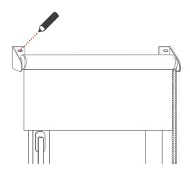
3 Fertig montiertes Rollo an Wand oder Decke anhalten, um Bohrlöcher anzuzeichnen (Öffnungen am Rolloträger dafür nutzen). Anschließend Löcher bohren und Dübel setzen.
