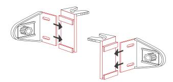
2 Die beiden Rolloträger in die vorderen Teile der Klemmträger schieben.
