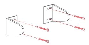
5 Rolloträger an Wand oder Decke anschrauben.
