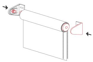
2 Rolloträger auf beide Seiten der Rollowelle aufstecken, um die Positionierung der Wand- bzw. Deckenhalter zu bestimmen.
