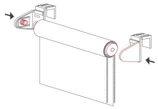
4 Rolloträger auf beide Seiten der Rollowelle aufstecken. Dabei beachten, dass der Kettenzug so positioniert wird, dass Kette problemlos abrollen kann.
