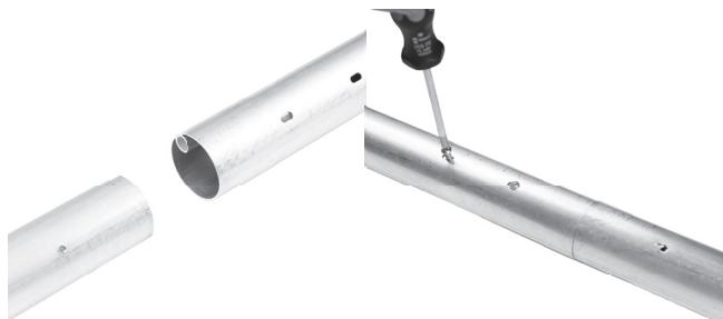
Stecken Sie die Tuchwelle (20) auf das Verbindungsstück und fixieren Sie dieses mit den Linsenkopfschrauben (2) beidseitig. Bei Markisenbreiten von 250 cm/295 cm verlängern Sie die Tuchwelle (20) nochmals mit einem Verbindungsstück und einer Tuchwelle (20). Fixieren Sie das Verbindungsstück mit weiteren 4 Linsenkopfschrauben (2).
