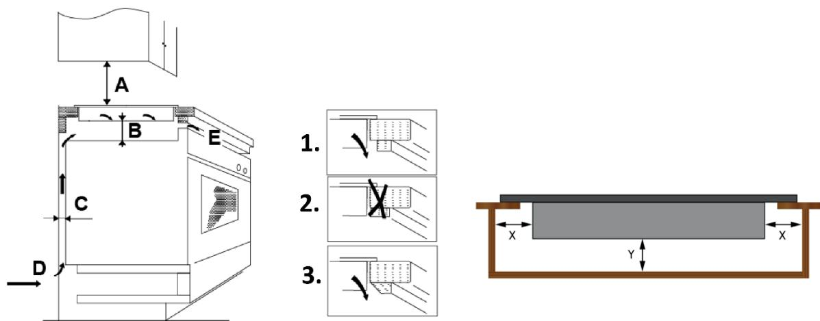
**D = BELÜFTUNGSSCHLITZ / E = LUFTAUSLASS**
