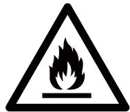
43. **WARNUNG!** Brandgefahr - brennbares Material. Bitte halten Sie das Produkt während der Verwendung, Wartung und Entsorgung von Feuerquellen fern. Es befinden sich brennbare Materialien auf der Rückseite des Geräts.
