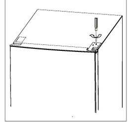
3. Schrauben Sie das mittlere Scharnier ab. Heben Sie dann die untere Tür an und legen Sie sie auf eine weiche Unterlage, um Kratzer zu vermeiden.
