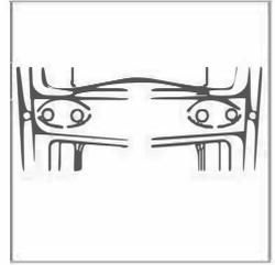
5. Schrauben Sie das untere Scharnier ab. Montieren Sie dann die verstellbaren FüÙe auf beiden Seiten ab.
