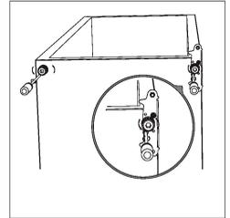
6. Schrauben Sie den Bolzen vom unteren Scharnier ab, drehen Sie die Halterung um und bringen Sie sie wieder an.
