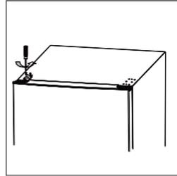
13. Befestigen Sie die Scharnierabdeckung auf der linken Seite und die Abdeckkappe der Scharnierbohrung auf der rechten Seite.
