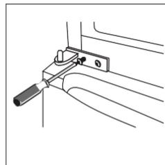
9. Setzen Sie die obere Tür wieder ein. Bevor Sie das obere Scharnier fest anziehen, vergewissern Sie sich, dass die Tür horizontal und vertikal richtig ausgerichtet ist, damit die Dichtungen an allen Seiten schließen. Setzen Sie dann das Scharnier ein und schrauben Sie es an der Vorderseite des Geräts an.
