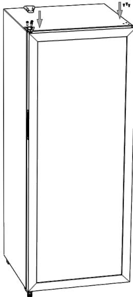
6.Schrauben Sie die 3 Schrauben auf das Türscharnier und legen Sie die 3 Schraubendeckel auf der anderen Seite.
