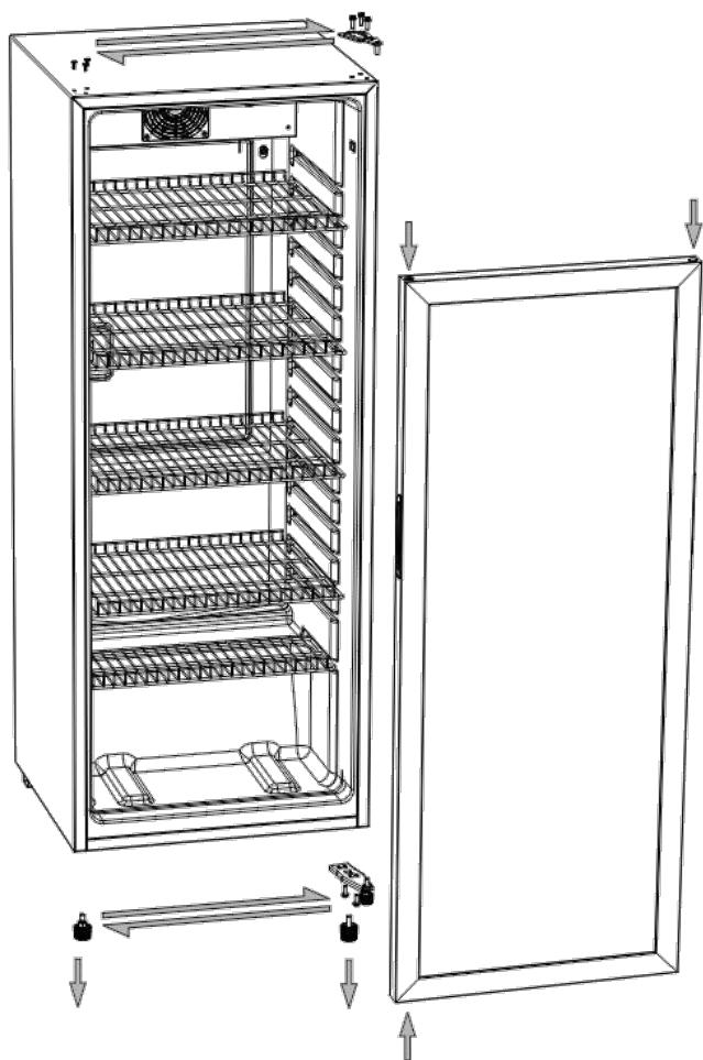
4. Entfernen Sie das untere Scharnier und den verstellbaren Fuß.
