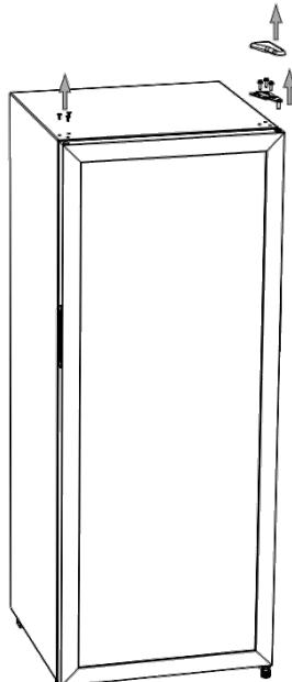
2. Entfernen Sie die 3 Schrauben für das Türscharnier und die 3 Schraubendeckel auf der anderen Seite des Türscharniers.
