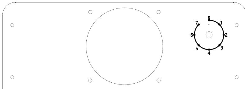
Wenn Sie Ihr Gerät zum ersten Mal in Betrieb setzen, stellen Sie den Thermostat in die Zwischenstellung "3" und lassen Sie ihn 4 Stunden lang leer laufen, bevor Sie Getränke darin lagern, damit es ausreichend gekühlt wird. Der Thermostat
