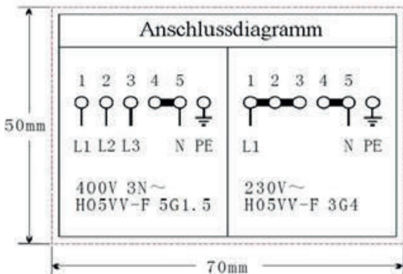
Spannung der Heizelemente 230V.
