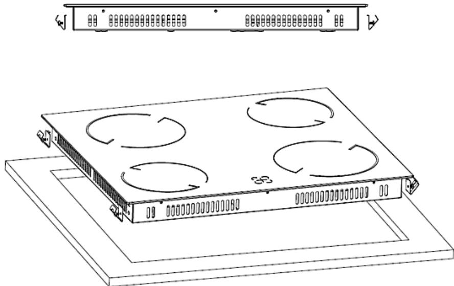
1. Bereiten Sie die Einbauöffnung entsprechend der Angaben auf der folgenden Abbildung vor.
