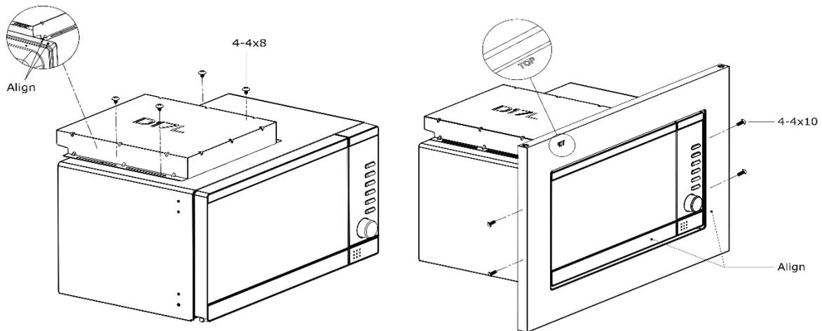
1. Mikrowelle vorsichtig in die Einbaunische setzen und zentrieren. Sicherstellen, dass das Gerät in der Mitte platziert ist.
