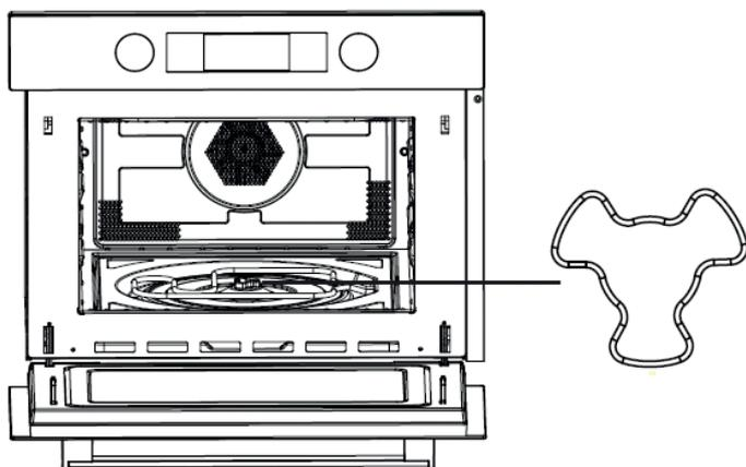
2. Justieren Sie den Winkel des Drehtellers und der Drehtellerachse.
