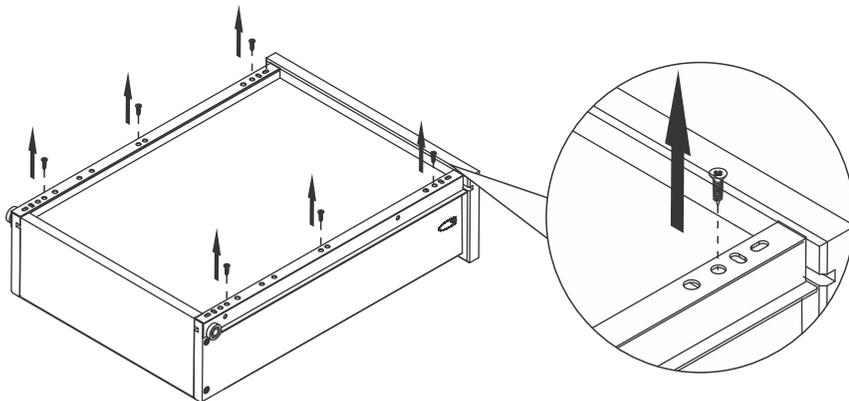
Zur Neu Befestigung der Schienen benutzen Sie die «querliegenden» Langlöcher vorne und hinten an den Schienen. Achten Sie dabei darauf, dass die Schubladenführungsschiene vorne an der Schubladenfront anliegt bzw. anstößt. Drücken Sie die Schiene fest an die Schubladenseitenwange und die Schrauben anschließen
