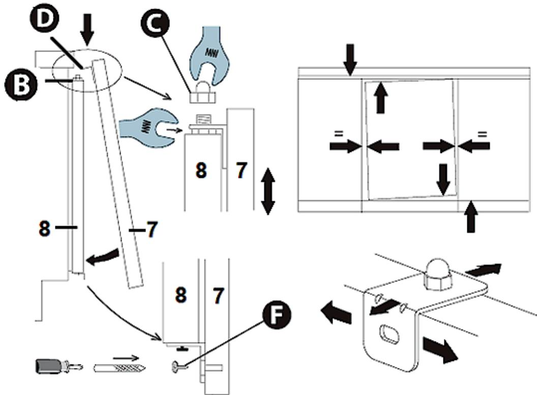
15. **BEFESTIGUNG DES GERÄTES:** Bohren Sie auf der **Unterseite** der Arbeitsplatte zwei Löcher an den entsprechenden Stellen (= Positionen der BAUTEILE « **A** »); s. Abb. unten.
