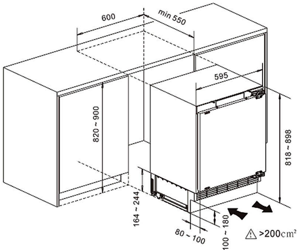
ERFORDERLICHE BELÜFTUNGSÖFFNUNG =  $>200\text{ cm}^2$
