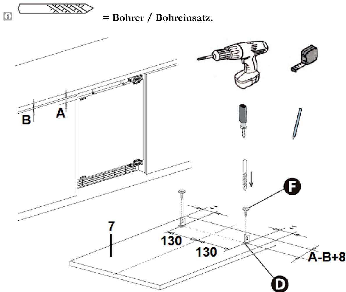
11. Hängen Sie die Tür des Einbaumöbels « 7 » mit den installierten BAUTEILEN « D » in die BAUTEILE « B » der Gerätetür « 8 » ein; s. Abb. unten.
