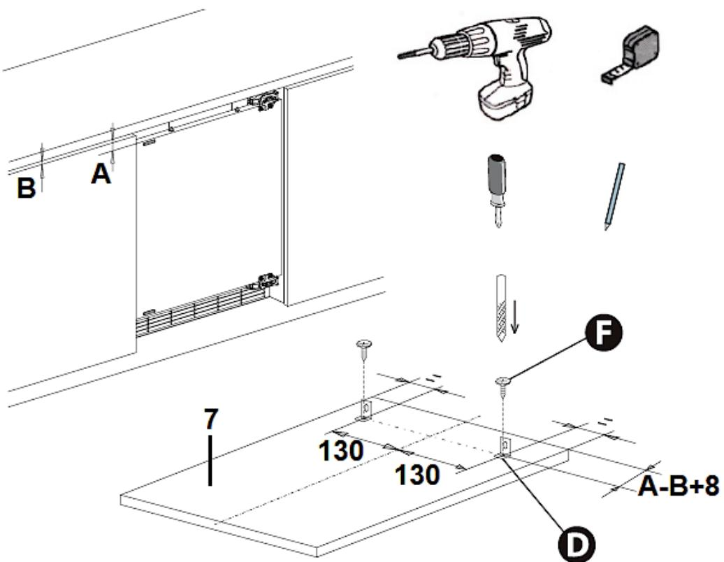
11. Install the door of the built-in furniture « 7 » with the installed PARTS « **D** » on the PARTS « **B** » of the appliance door « 8 »; s. fig. below. Fix the door of the built-in appliance properly using the parts « **C** »; s. fig. below.
