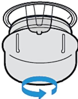
4. Entfernen Sie das Leuchtmittel aus der Fassung (s. Abb. unten) und ersetzen Sie dieses durch ein neues Hochtemperatur-Leuchtmittel ( $300^{\circ}\text{C}$ ) **gleicher Art**. Benutzen Sie **keinen** anderen Leuchtmittel-Typ.
