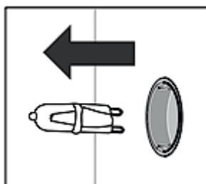
5. Setzen Sie das neue Leuchtmittel ein und überprüfen Sie sorgfältig, ob dieses sich ordnungsgemäß in seinem Sockel befindet.
