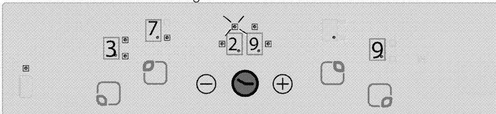
Zeigen Sie die verbleibende Zeit des Kochzonentimers 3 (LED blinkt) im Timerdisplay an (die LEDs der aktiven Timer der Kochzonen 1 und 4 sind im Timerdisplay nicht sichtbar).
