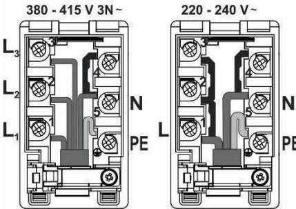
Schließen Sie das Gerät mit einem dreidradigen Kabel vom Typ H05VV-F5G1,5 (früher CGLG 5Cx1.5) an (Schutzschalter 3x16 A).
