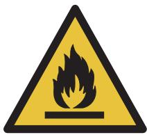
48. **WARNUNG!** Feuergefahr - zündfähiges Material. Bei der Instandhaltung und Entsorgung das Gerät von Zündquellen fernhalten. Auf der Rückseite des Geräts befinden sich zündfähige Materialien.
