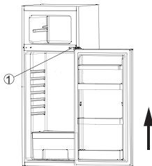
4. Tauschen Sie die Position des unteren Scharniers und des verstellbaren Fußes auf der anderen Seite des Schranks aus.
