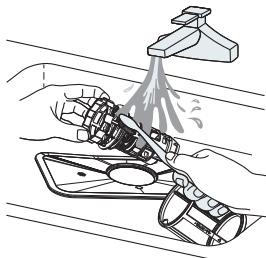
**3** Größere Speisereste können durch Spülen des Filters unter fließendem Wasser gereinigt werden. Für eine gründlichere Reinigung verwenden Sie eine weiche Reinigungsbürste.
