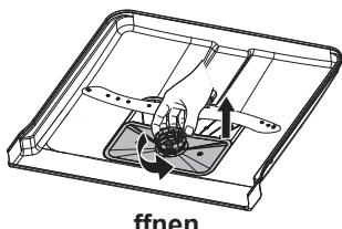
**1** Halten Sie den Grobfilter fest und drehen Sie ihn gegen den Uhrzeigersinn, um den Filter zu entriegeln. Heben Sie den Filter nach oben aus der Spülmaschine.
