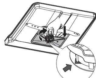
**4** Setzen Sie die Filter in umgekehrter Reihenfolge wieder zusammen, setzen Sie den Filtereinsatz wieder ein und drehen Sie ihn im Uhrzeigersinn bis zum Schließpfeil.
