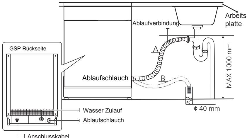
**So lassen Sie überschüssiges Wasser aus Schläuchen ab:** Wenn der Anschluss zum Abflussrohr höher als 1000 mm positioniert ist, kann überschüssiges Wasser im Ablauchschlauch verbleiben. Überschüssiges Wasser aus dem Schlauch muss in eine Schüssel oder einen geeigneten Behälter abgelassen werden, der außerhalb und unterhalb des Waschbeckens steht.
