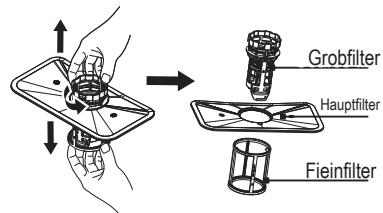
**2** Der Feinfilter kann vom Boden der Filtereinheit abgezogen werden. Der Grobfilter lässt sich vom Hauptfilter lösen, indem man die Laschen oben leicht zusammendrückt und wegzieht.
