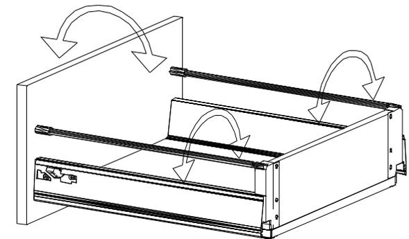
**Mit Drehung der STR-Reling nach "links" wird die Front "waagrecht" eingestellt.
