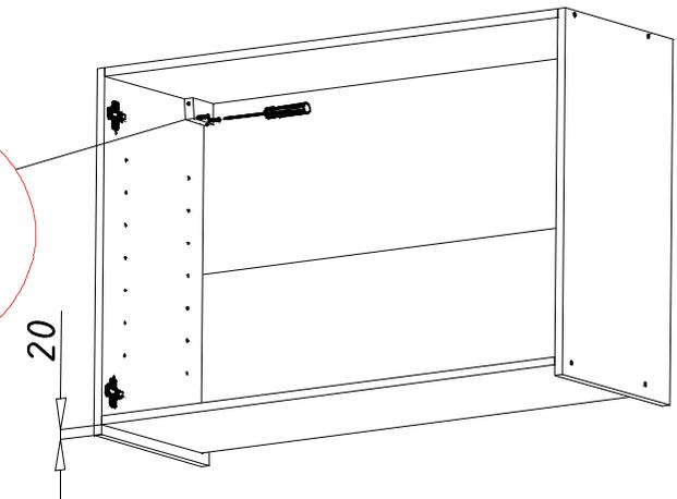
Bauteil AK103 muss an der linken und an der rechten oberen Ecke vom Hängeschrank montiert werden.
