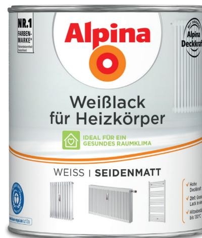
Alpina Weißlack für Heizkörper kann gestrichen, gerollt oder gespritzt werden. Vor Gebrauch gut aufrühren und bei Bedarf für die Grundierung mit max. 5 % Wasser verdünnen. Für die Pinselverarbeitung hochwertigen Acrylpinsel (Mischung aus Synthetik- u. Naturborsten) einsetzen. Auf größeren Flächen den Lack mit einer kurzflorigen Nylonrolle (4–6 mm Florhöhe) auftragen und sofort mit einer feinporigen Schaumstoffrolle oder einem Acrylpinsel nacharbeiten.
