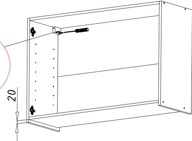
Bauteil AK103 muss an der linken und an der rechten oberen Ecke vom Hängeschrank montiert werden. Die konkrete Einstellung von AK103 wird auf letzter Seite ersichtlich!
