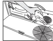
Wenn sich auf der Lüfterabdeckung und der Bordplatte Faser ansammelt, entfernen Sie diese mit einem Tuch.
