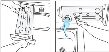
Wenn sich im Trichter des Wassertanks Fasern angesammelt haben, entfernen Sie diese unter fließendem Wasser.
