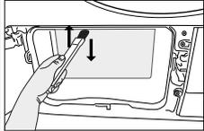
Sie können einen Staubsauger mit einer Bürste zum Reinigen verwenden. Wenn der Staubsauger keine Bürste hat, wird nicht empfohlen, ihn für die Kondensatorreinigung zu verwenden.
