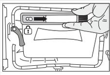
Ziehen Sie nach dem Reinigen des Filters, der Tür und des Kondensators die Bürste nach rechts und verriegeln Sie sie.
