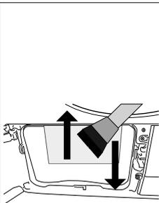
Reinigen Sie die Faser auf der Metalloberfläche des Kondensators mit einem feuchten Tuch oder der Bürste am Luftleitblech nach oben und unten. Reinigen Sie nicht von links nach rechts, da dies die Metallplatten des Kondensators beschädigen kann.
