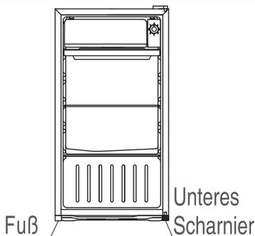
3. Entfernen Sie den Fuß und das untere Scharnier und befestigen Sie sie auf der gegenüberliegenden Seite.
