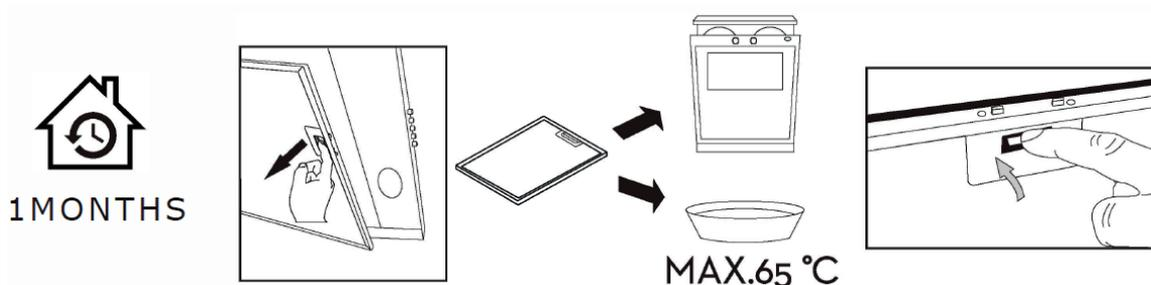
Nach mehreren Reinigungsvorgängen kann sich die Farbe des Metallfilters verändern. Dies ist ein normaler Vorgang und kann nicht zum Austausch des Filters unter Garantie führen. Er beeinträchtigt in keiner Weise die Funktionsfähigkeit der Haube.
