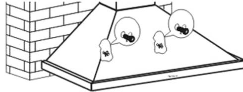
10. Den Luftauslassdeckel im Abluftstutzen der Dunstabzugshaube befestigen (wenn nicht bereits vormontiert).
