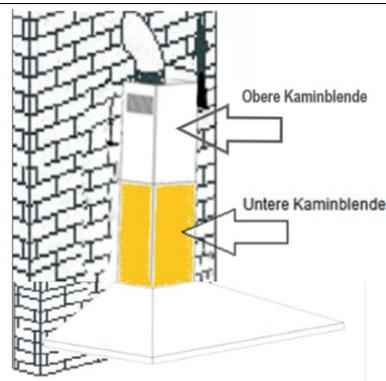
14. Zur Montage der oberen und mittleren Kaminhalterung eine Senkrechte nach oben ziehen.
