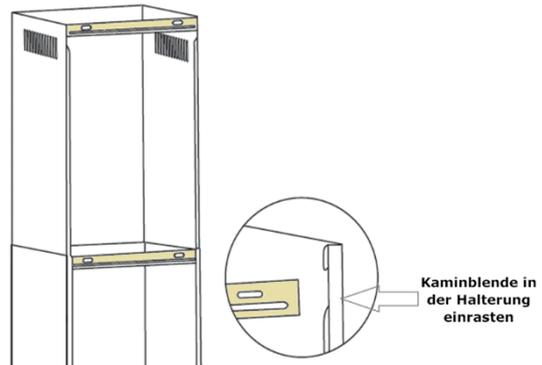
19. Die obere Kaminblende mit der oberen Kaminhalterung verbinden, welche bereits an der Wand montiert ist.
