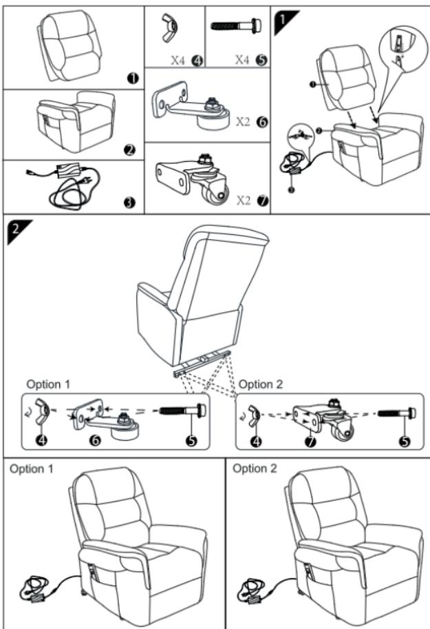
DE: Bitte stellen Sie sicher, dass das Stromkabel nicht unter dem Metallrahmen verläuft
